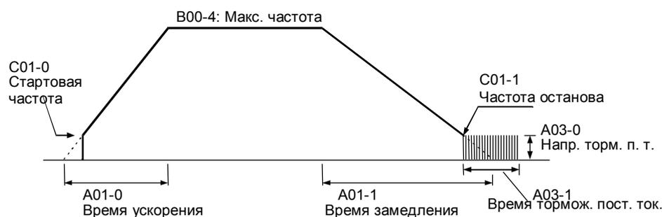
Это время разгона/торможения привода при нормальной работе (при выключенной команде CSEL). Инвертор может не отключиться, если установленное время слишком мало.
