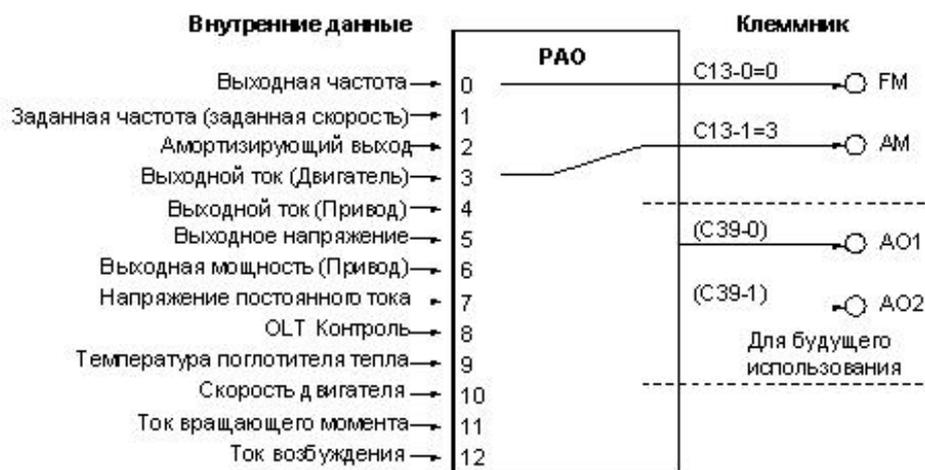
Рис. 5-8 Функции аналогового выхода
